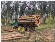
Expediční vozík na přepravu krátkého dřeva s odnímatelným košem na sloupky.
