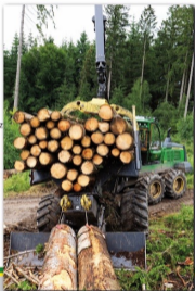
Expediční vozík na přepravu krátkého dřeva s odnímatelným košem na sloupky.
