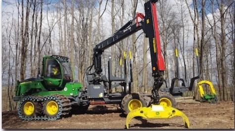
1. HAAS-ÖSA Klemmbank für zwei verschiedene Positionen, zweite Rung und Stirngitter horizontal verschiebbar.
