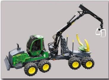
HAAS Verschiebebeck, Stirngitter hinten, Klemmbank eingefahren. Verkürzt den Hinterwagen und erhöht den Seileinlauf.
