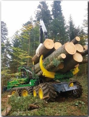
HAAS-ÖSA Klemmbank mit ausgefahrenem Verschiebebeck für Kurzholz.
