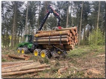
Forwarder im Kurzholztransport mit abnehmbarem Rungenkorb.
