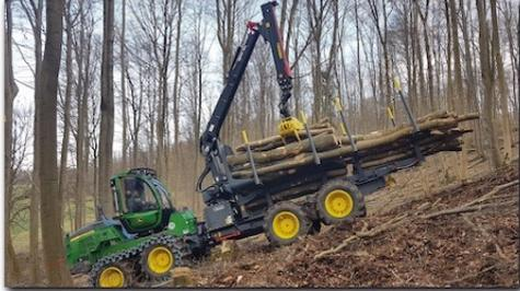
2. Rungenkorb mit zwei Rungen, zweite Rung horizontal ausziehbar (Sortiment 2x3m).
